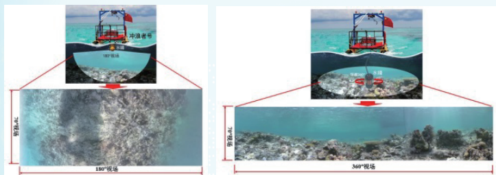
图1 水下环视摄像机的下视及环视工作模式（左图下视模式，右图环视模式）
