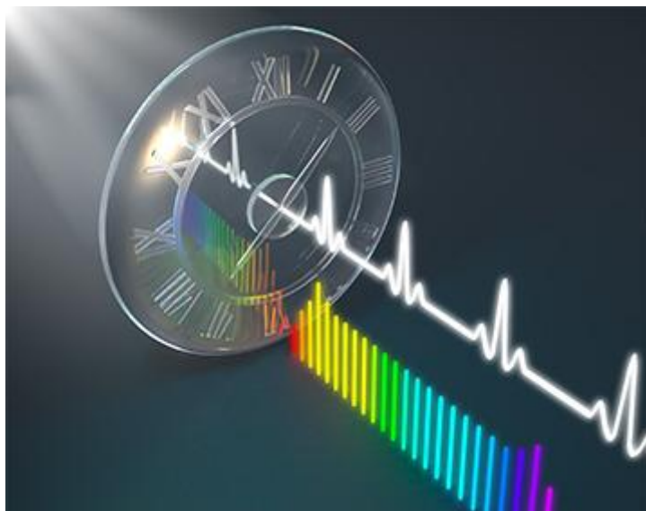
图 5 时间透镜将连续波单色激光束转换为高性能片上飞秒脉冲源
