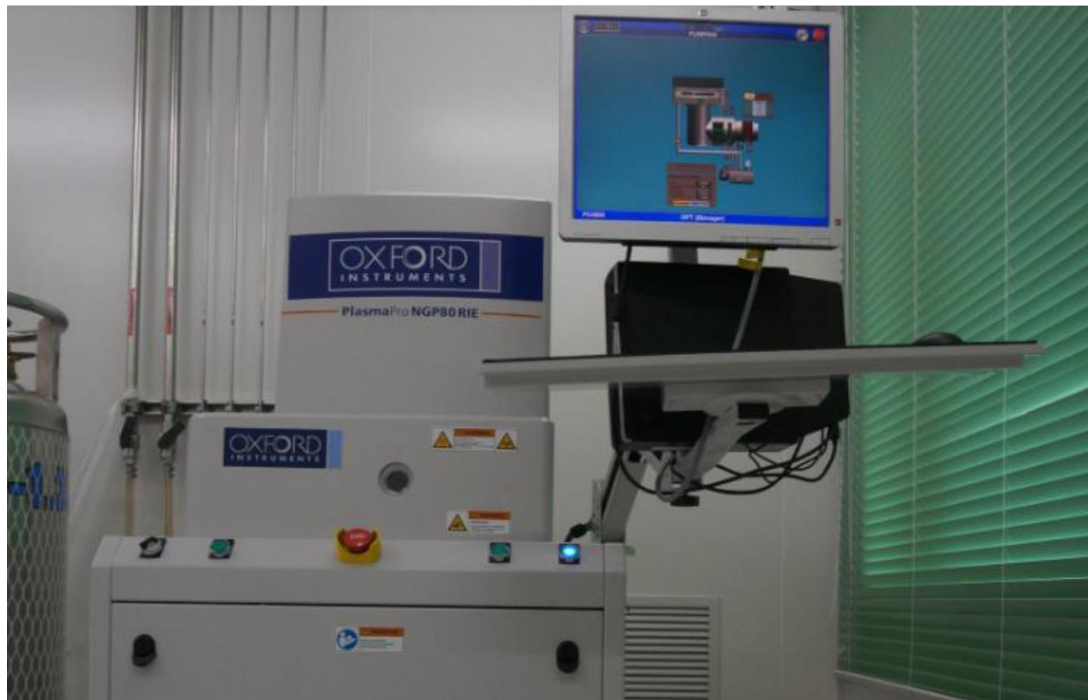
图 5-11 反应离子刻蚀系统（英国牛津仪器 PlasmaPro NGP80）
