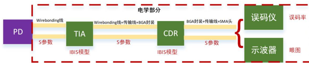
图 2.16 接收端封装结构框图
