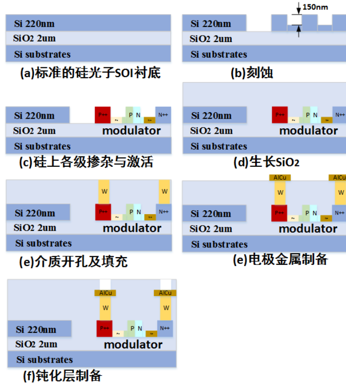
图 4.11 调制器工艺流程步骤
