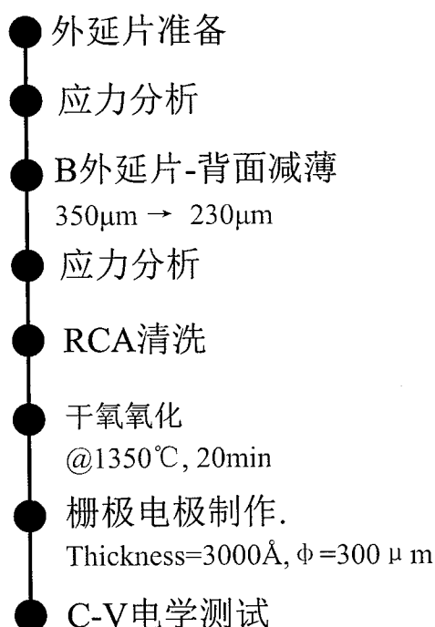
图 3.11 SiC MOS 电容工艺流程方案
