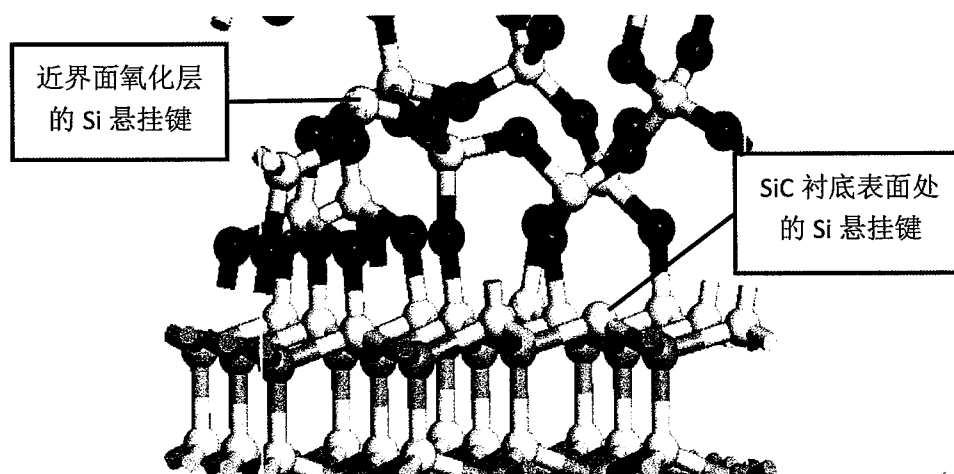
图 2.2 SiC/SiO 2 界面中的 Si 悬挂键
