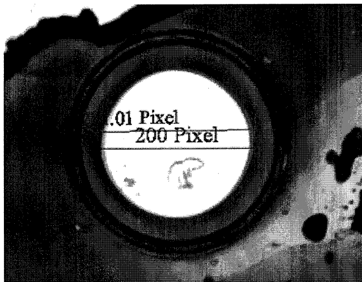
图 4-4: 氧化深度的确定,其中圆形台面直径已知,与台面尺寸进行对比就能获知氧化深度。
