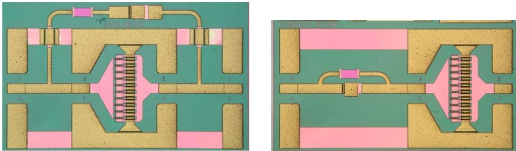
图 5.29 添加 RC 稳定电路的功率管
