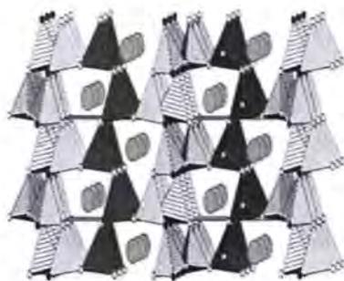
图 1.19  $\text{BiB}_3\text{O}_6$  的晶体结构图<sup>[64]</sup>
