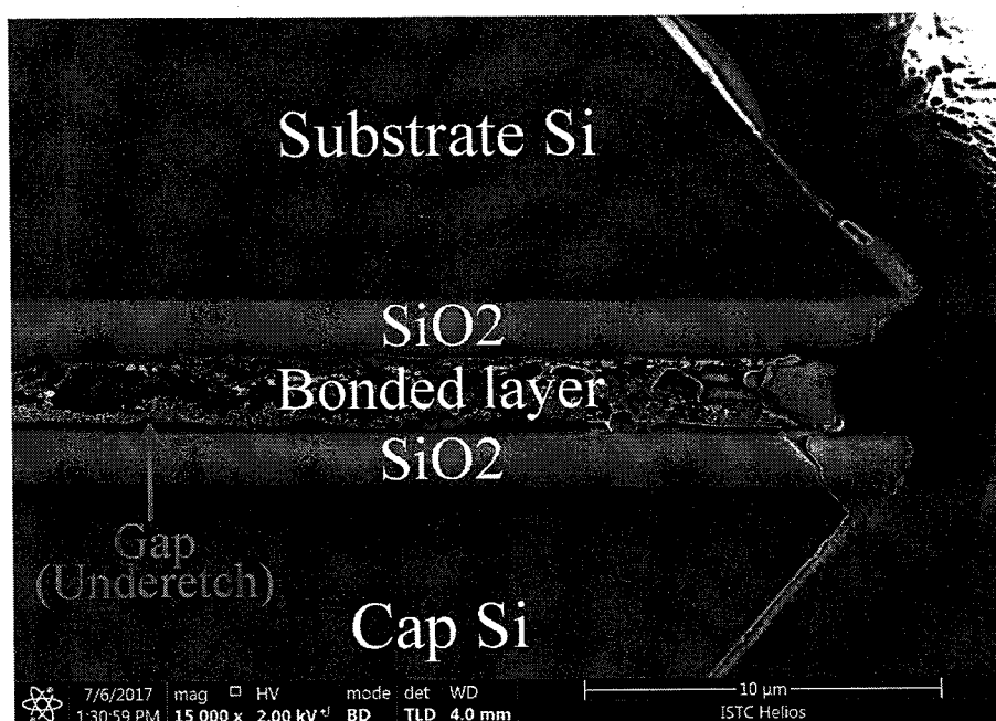
图 2.11 \alpha -Si 与 Au 厚度比为 12.5:1 的 Au/ \alpha -Si 键合芯片单元在 90 min 的 KOH 腐蚀后边 界经由 FIB 处理后的 SEM 照片。
