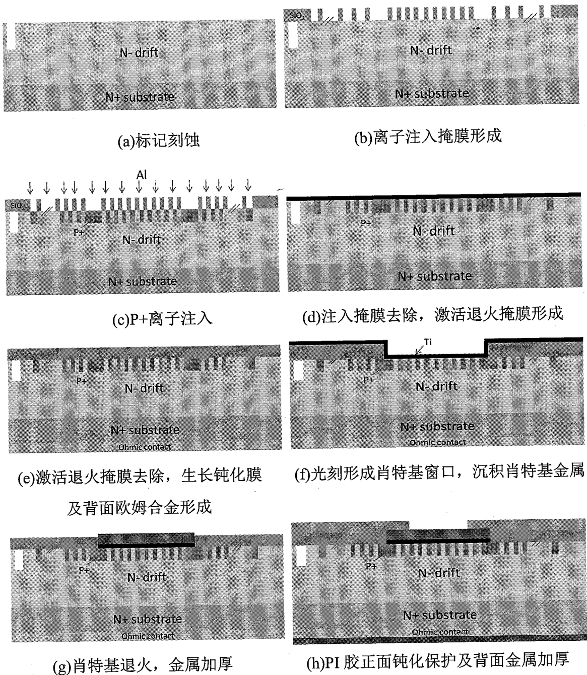
图 3.2 4H-SiC JBSs 器件制备简化流程
