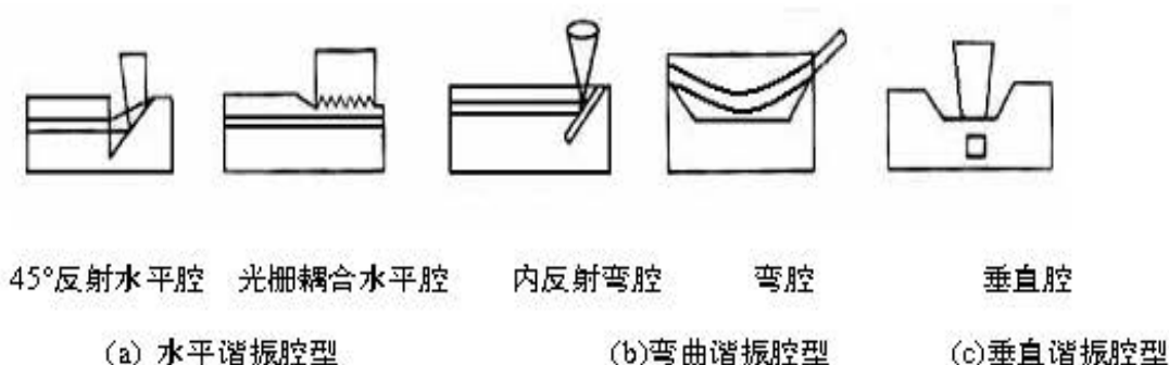
图 1.1 面发射激光器的三种结构
