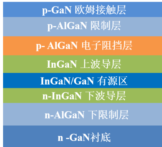
图 1.5 GaN 基绿光激光器的外延结构示意图
