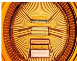
图 1.11 宝石电极引线结构
