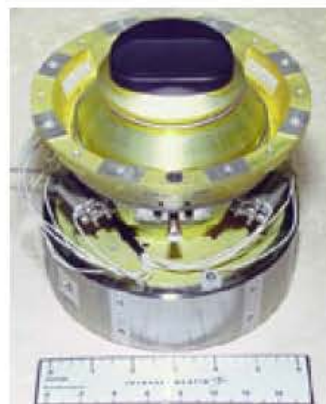
图 2.1 美国 AIRS 红外焦平面用微型杜瓦
