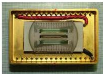
图 5-1 256 元 InGaAs 线列探测器封装后照片
