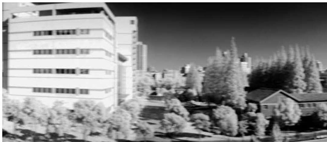
图 5-12 SU1024LE 探测器成像效果(未经非均匀性校正)
