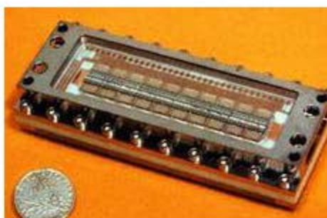
图 1-7 SPOT-4、SPOT-5 卫星的 3000 元 InGaAs 线列探测器
