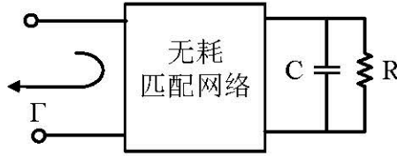
图 3-7 并联 RC 阻抗的无耗匹配网络
