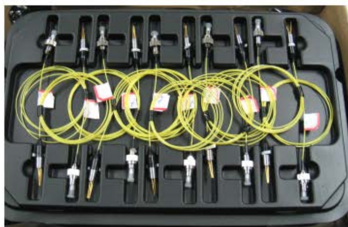
图 3.16 APD 的 TO 封装原型图
