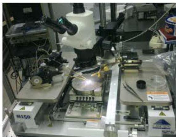
图 3.12 线性模式 I-V (C-V) 测量的探针台
