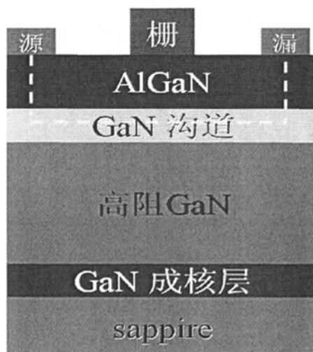
图 3.1 GaN 基 HEMT 器件结构示意图
