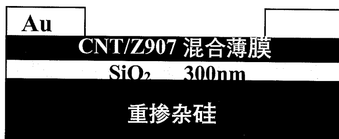
图 4.16 CNT/Z907 体异质结构晶体管示意图
