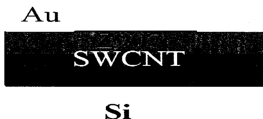
图 4.6 CNT/Z907 光电晶体管剖面图
