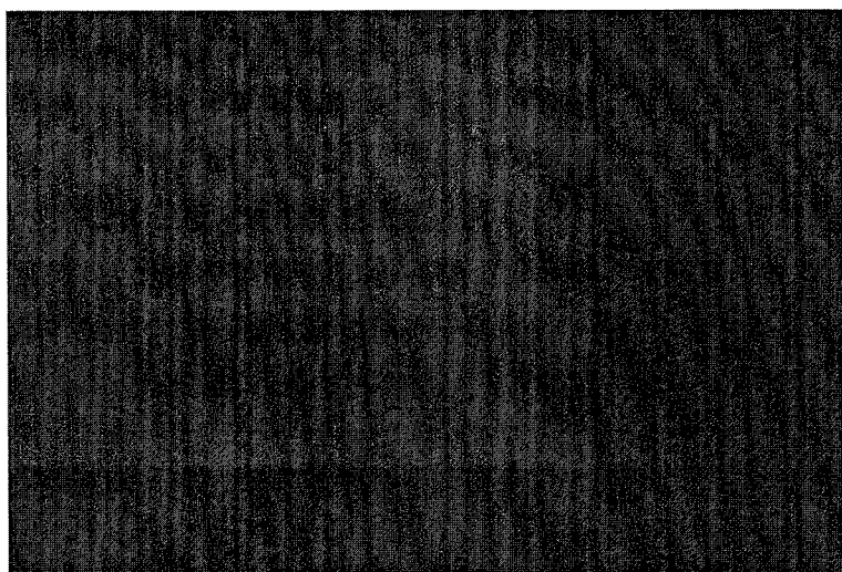
图 5.11 加入转动工程漫射体后用 1/80 秒的曝光时间拍摄的散斑图像
