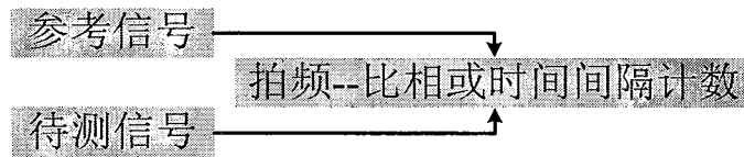
图 4.2 绝对特性测量方案示意图
