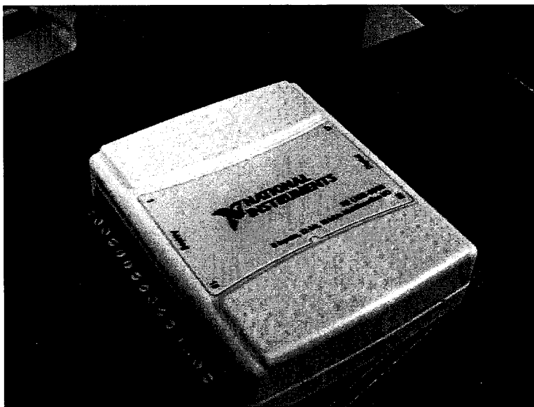
图 2-23 用于控制遮光片驱动器马达的 National Instruments 控制器
