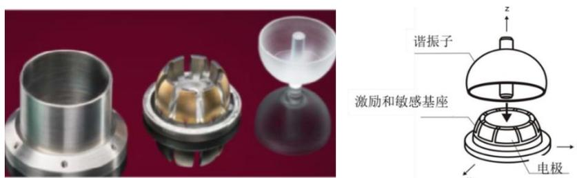
图 2.7 Northrop Grumman “二部件”式半球陀螺仪实物与示意图
