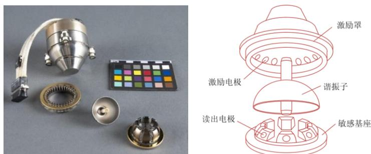
图 2.6 Northrop Grumman “三部件”式半球陀螺仪实物与示意图
