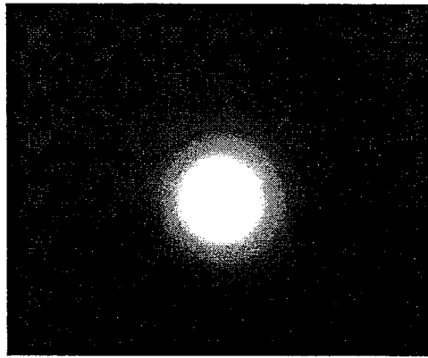
图 5.9 500mW 绿光输出远场光斑
