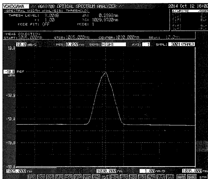
图 4-30 利用 FBG 实现锁模的输出光谱
