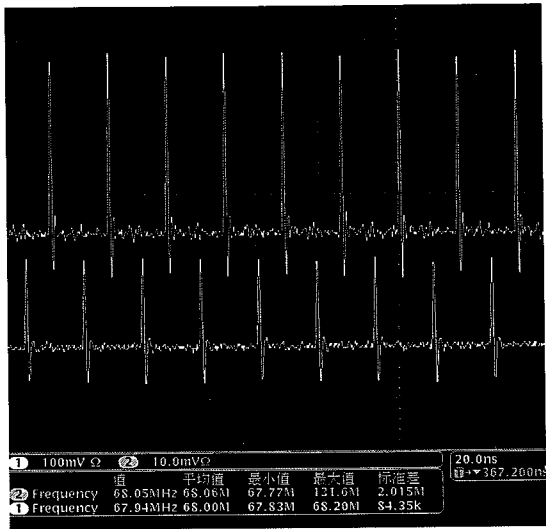
图 4.4 腔长完全同步下的钛宝石激光器与皮秒泵浦激光器锁模序列图：上面为钛宝石激光器输出脉冲序列；下面为皮秒激光器输出脉冲序列
