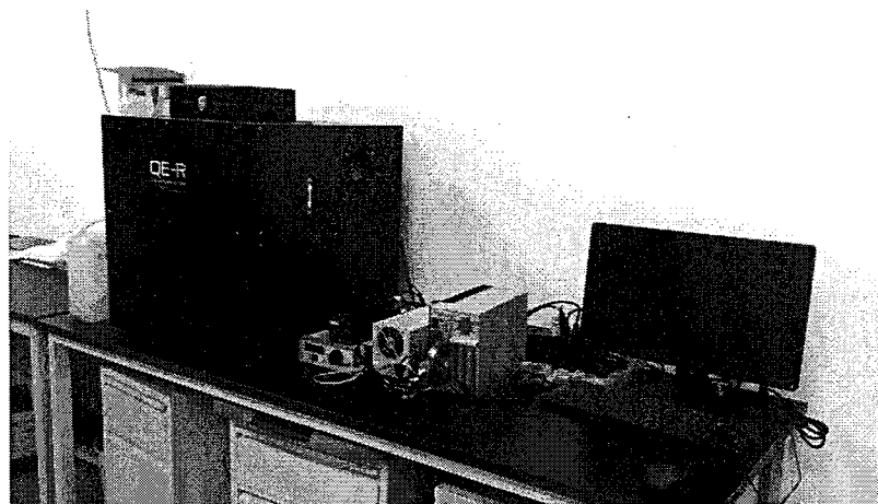
2.13 钙钛矿太阳能电池 EQE 测试系统
