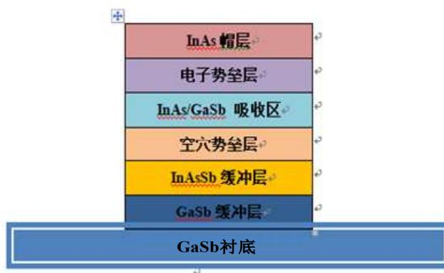
图 4.2 PBIBN 型长波 InAs/GaSb II 类超晶格器件材料外延结构示意图
