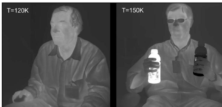
图 1.11 10  $\mu\text{m}$  中心距  $2\text{K} \times 2\text{K}$  红外焦平面在 120 K 和 150 K 温度下的成像[25]
