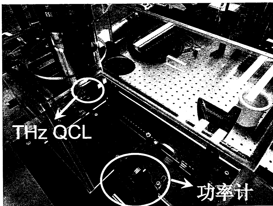
图 3.5 LIV测量实验示意图，整个系统置于密闭环境内并填充氮气降低湿度，THz QCL则工作在连续波模式下
