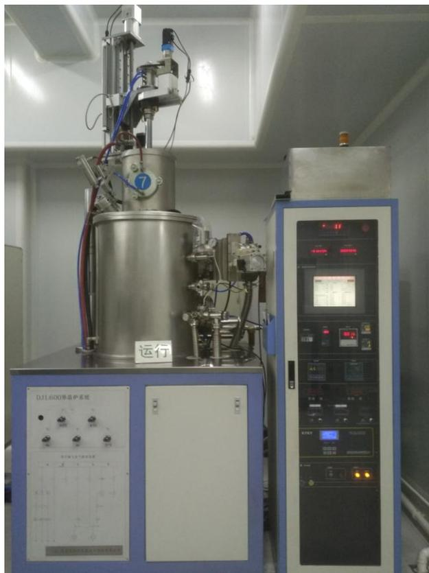
图 2.1 采用液相法生长 SiC 晶体的设备
