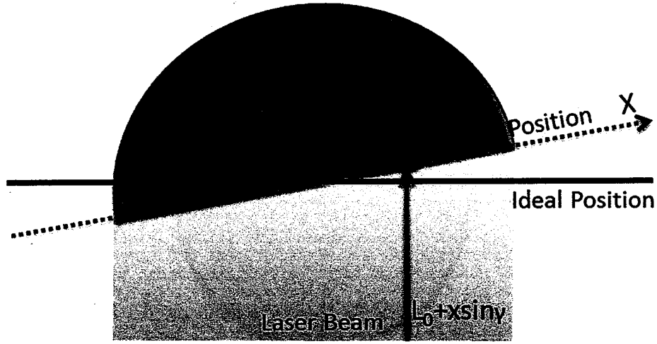
图2.20 四象计光电探测示意图。其中QPD为四象计,Laser Beam为入射激光束,Ideal Position为四象计光敏面理想位置,Real Position为四象计光敏面实际位置。
