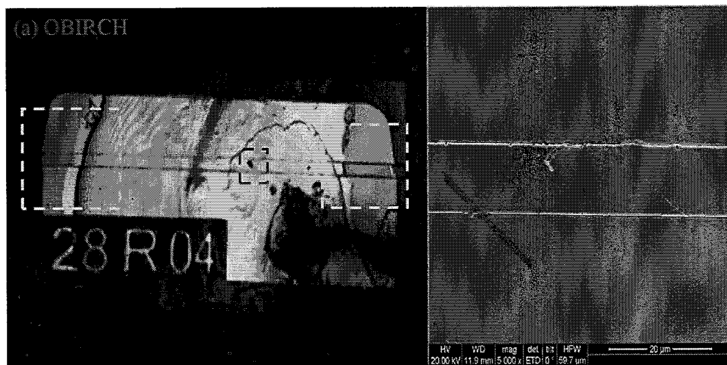
图 3-13 有孔洞的激光器漏电定位结果
