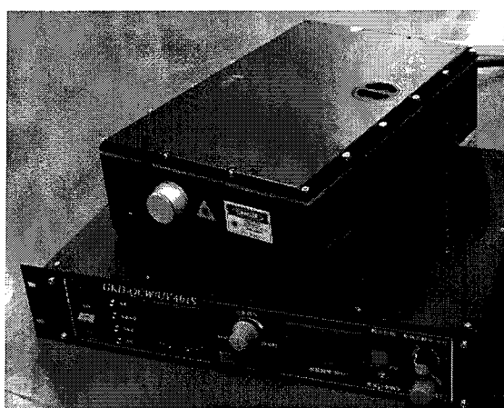
图 6.14 1.8W 端泵紫外激光器样机图片
