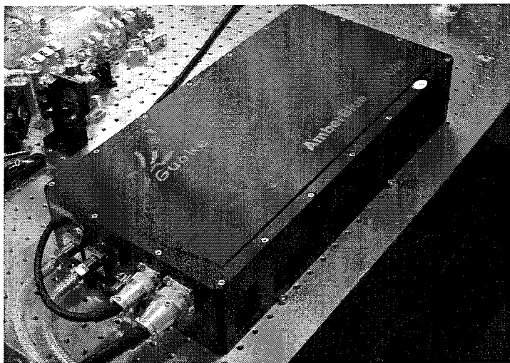
图 5.21 4.2W 全固态连续波蓝光激光器的样机图片
