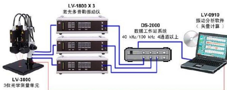
图 1.14 LV-3800 型三维激光相干多普勒测振系统
