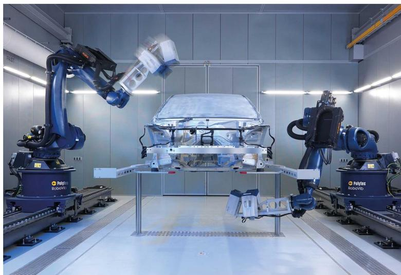
图 1.11 RoboVib 型结构测振站
