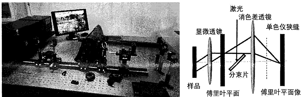
图表 2.7 角分辨荧光系统实物及原理图
