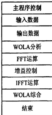
图 3.9 主程序指令模块分布结构图
