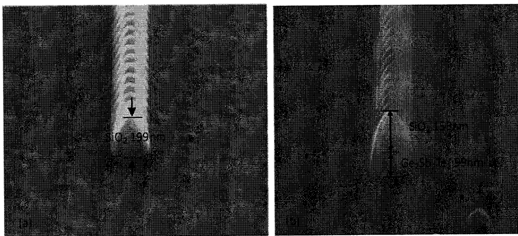
图 3.1 (a) FIB 沉积 \text{SiO}_2 纳米线条 SEM 图及厚度尺寸, (b) \text{Ge}_2\text{Sb}_2\text{Te}_5 刻蚀后纳米线条 SEM 及厚度尺寸
