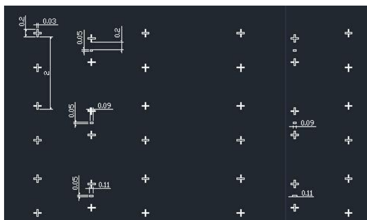
图 3.4 器件台面刻蚀光刻版
