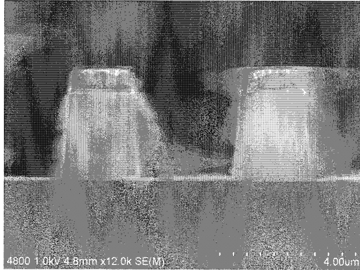
图 5-1 a-Si/ \text{SiO}_2 /a-Si 掩膜的横截面 SEM 图像，刻蚀截止在下层的 a-Si 处
