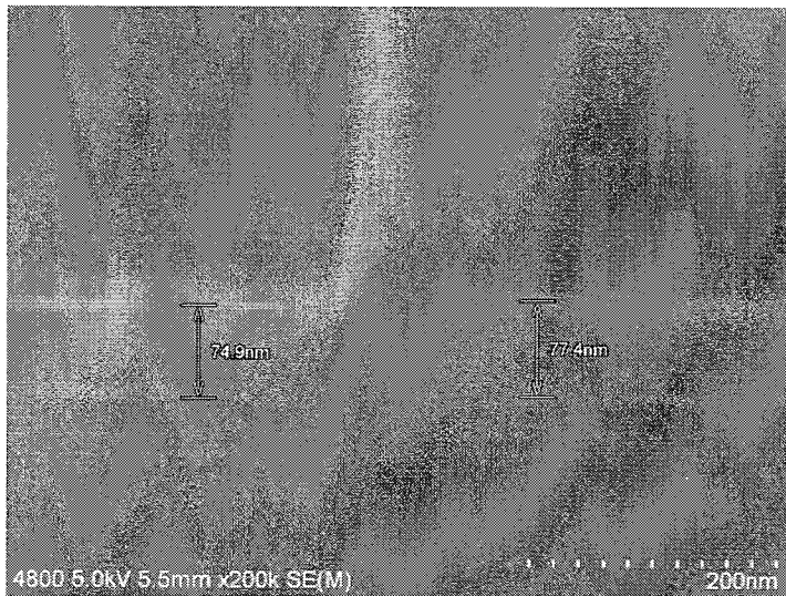
图 5-2 a-Si 截止层的横截面 SEM 图像
