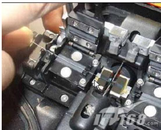
图 2-15 光纤熔接机
