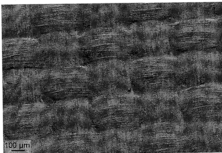
图 5-5 特氟龙材料表面的扫描电镜照片
