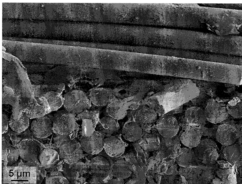
图 5-10 导电布电极材料的断面微观形貌
