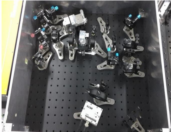
图 3.6 用于拍频的  $f-2f$  系统实验装置图
