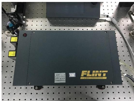
图 3.1 商用 Yb:KGW 全固态飞秒振荡器
