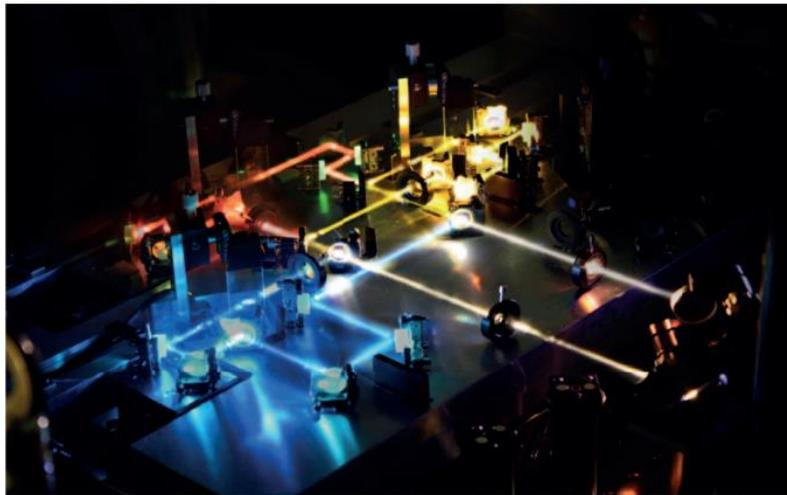
图 1.4 相干合成实验装置[87]
