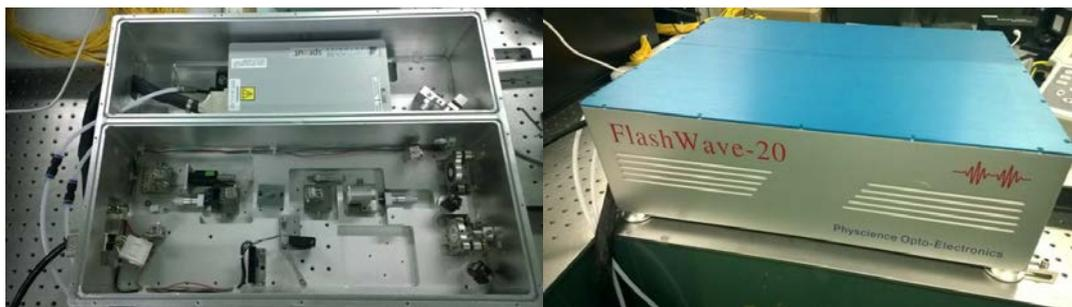
图 7.4 钛宝石激光振荡器的内部结构（左图）和整体外观（右图）
