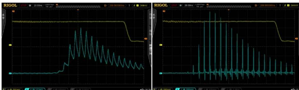
图 3.19 钛宝石激光再生放大器腔内脉冲建立的包络 左图：种子未注入时的调 Q 脉冲包络；右图：种子注入后的脉冲放大包络
