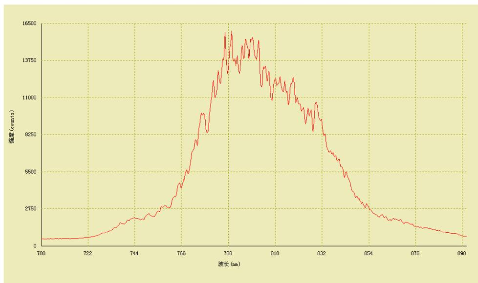
图 7.2 钛宝石激光振荡器的输出光谱
