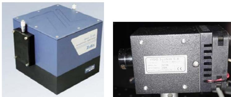
图 5.8 测量中红外激光光谱使用的仪器 单色仪（左图）和碲镉汞红外探测器（右图）
