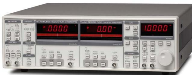
图 5.10 提取碲镉汞探头探测的微弱信号使用的锁相放大器
