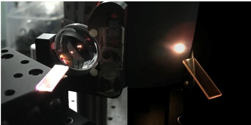
图 6.6 中红外飞秒激光在 MgO:CPPLN 晶体产生白光激光的实验照片
