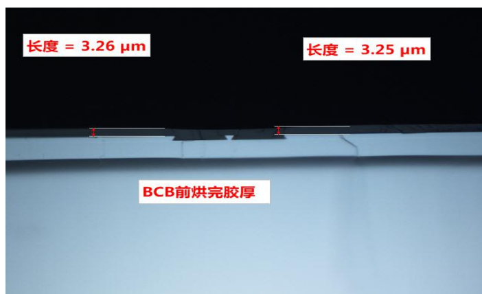
图 4.6 旋涂 BCB 后脊型的端面图
