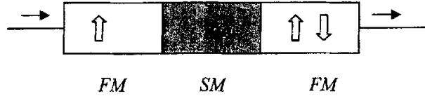
(图 2-3-1 左右 FM 为铁磁体, 中间层 SM 为半导体)
