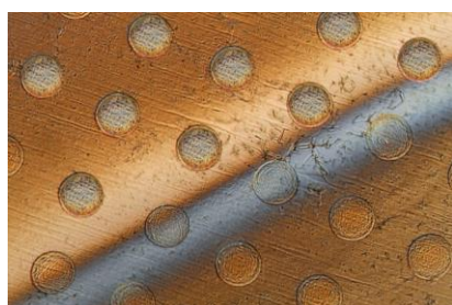
通过可控压力分裂使石墨烯片上 圆点与片材分离
