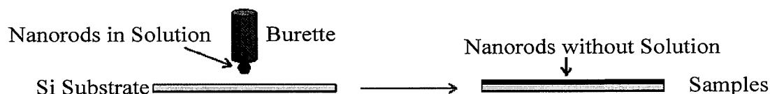
图 9-3.准备光学实验用纳米棒样品的过程。
