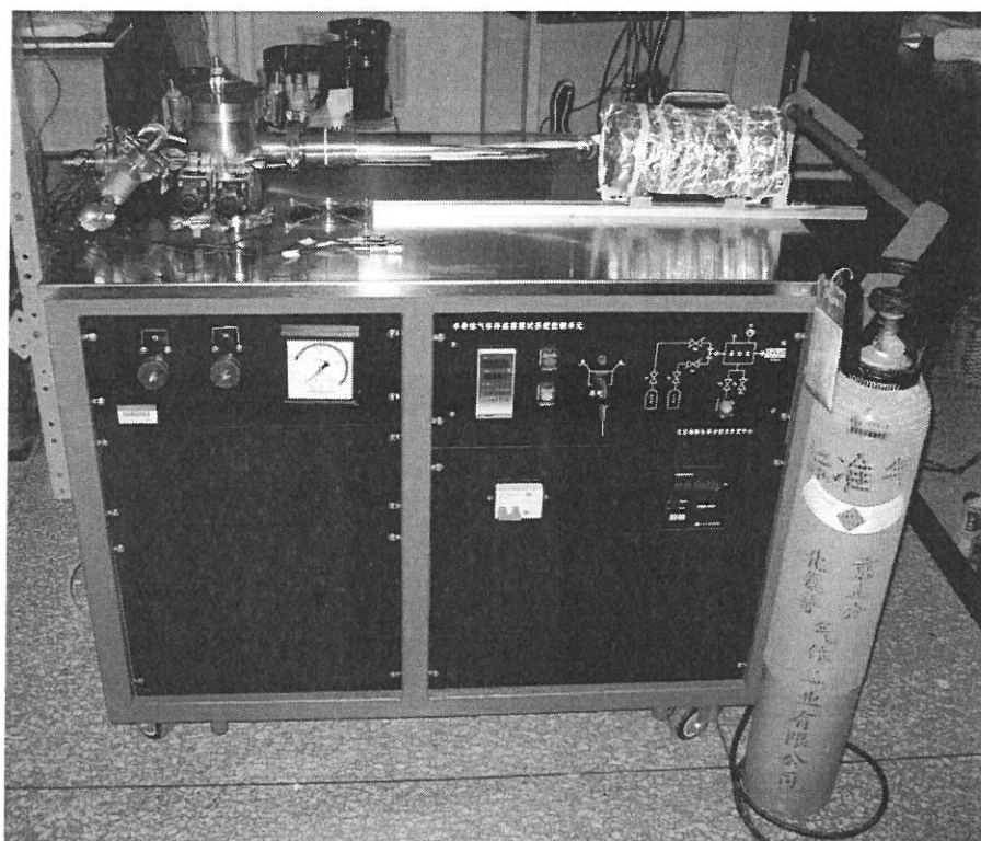
图3.5 半导体气体传感器测试系统照片
