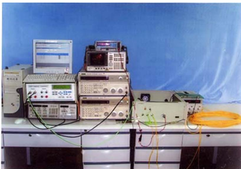
图 7-5 利用通道模拟器搭建的移相测试系统
