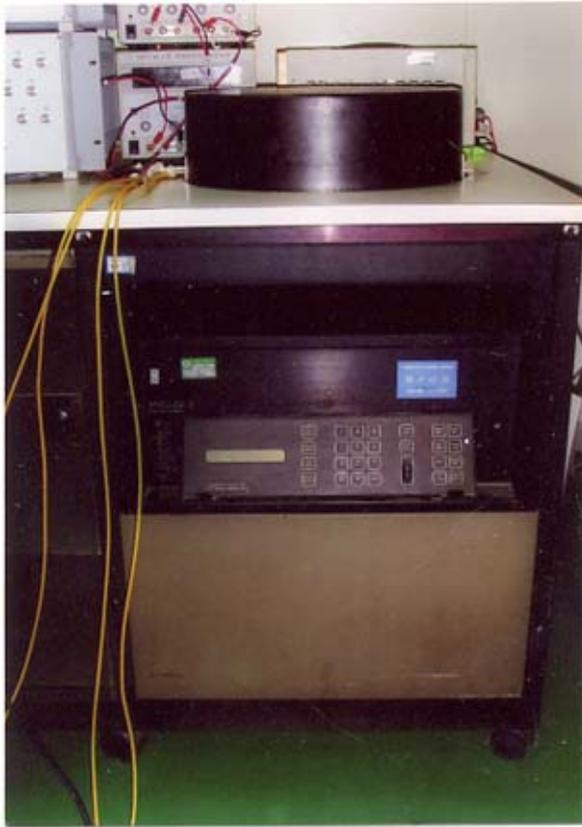
图 7-7 用于控制光纤电长度的程控温箱
