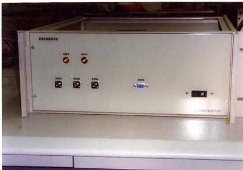
图 7-3 射频传输稳相系统的机箱面板
