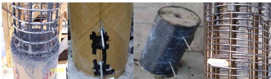
图 桥梁柱的组成左起依次为：水泥-聚乙烯纤维、玻璃钢、碳纤维、镍钛合金
